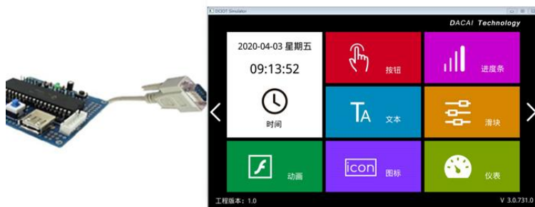
图 13-2 用户单片机串口与“虚拟串口屏”联机调试
